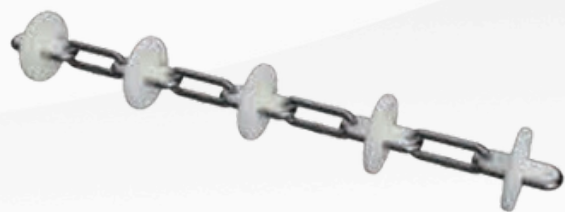
Corrente com discos D43mm com injeção completa para ChainLine 60; material: Liga de aço/PA
