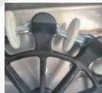
Roda motriz para unidade motriz 60; material: Liga de aço, endurecido
