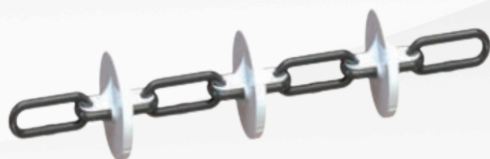
Corrente com discos D48mm de injeção completa para ChainLine 60; material: Liga de aço / PA GF30
